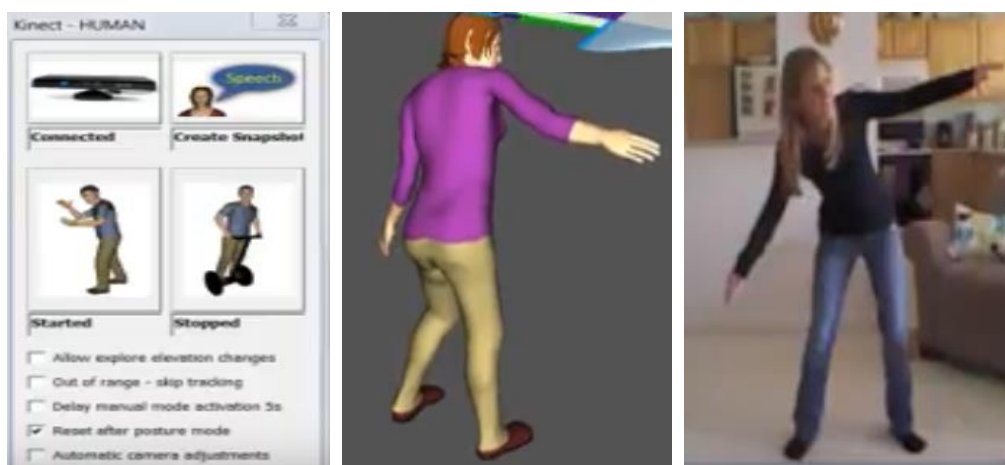
Obr. 5. Tecnomatix Jack pozicování modelu pomocí Kinect 360 senzoru (zdroj: Siemens PLM)
